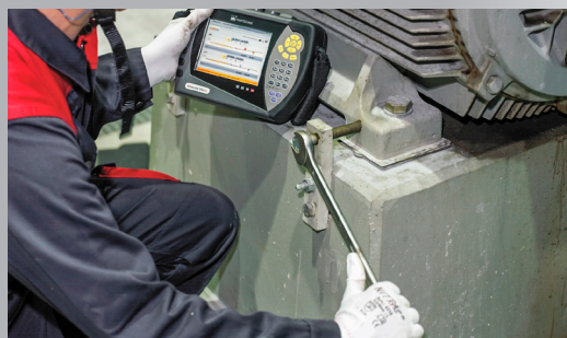
Corrección de la alineación vertical y horizontal Supervisión simultánea, en vivo, de las correcciones de la máquina en las direcciones vertical y horizontal. Los calzos PERMABLOC® de los tamaños apropiados simplifican el proceso de subir y bajar la máquina.
