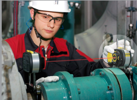
Ajuste del haz láser Los cuatro LEDs de ajuste hacen extremadamente fácil el centrado del haz láser.
