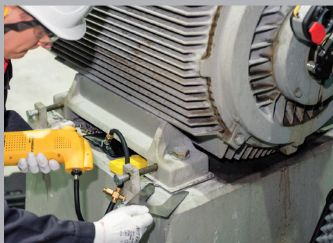
Corrección de la alineación vertical y horizontal Supervisión simultánea, en vivo, de las correcciones de la máquina en las direcciones vertical y horizontal. Los calzos PERMABLOC® de los tamaños apropiados simplifican el proceso de subir y bajar la máquina.
