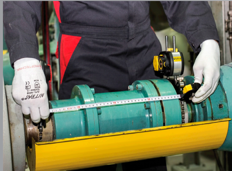
Introducción de dimensiones El sensor necesario y la superficie ocupada de la máquina se introducen rápidamente.
