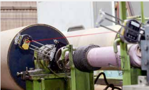
El juego de soportes para 180° de rotación solo requiere dos lecturas.
