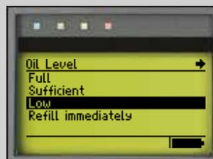
En una lista aparecen las inspecciones visuales que se pueden seleccionar y en las cuales se introducen datos de inspecciones (ejemplo: 'chequear nivel de aceite')
