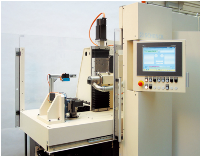
Dispositivo de fresado de disposición horizontal para la corrección radial del desequilibrio sobre una brida articulada. Si no puede eliminarse el desequilibrio en una sola operación de fresado, la corrección se efectúa en elementos múltiples como sea requerido.
